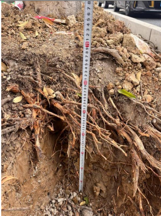
全路段，表土可剥离区（树池，约0.13hm 2 ），根据设计资料显示表土厚度约70cm
