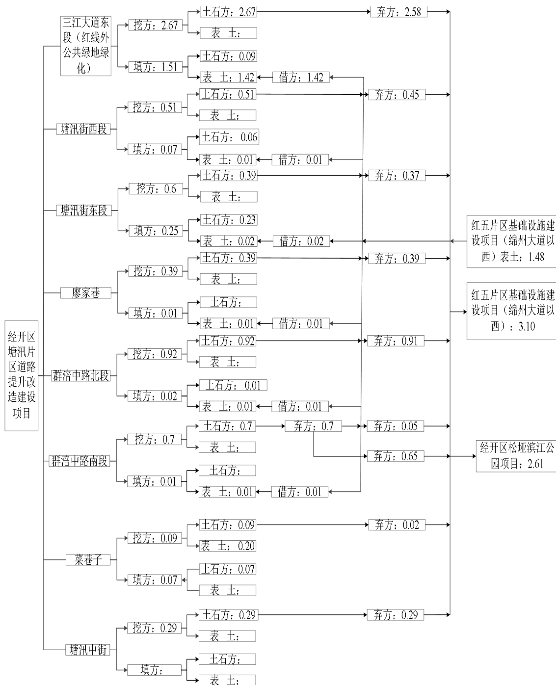
图 2.4-1 土石方平衡流向框图 单位: (万 m³)
